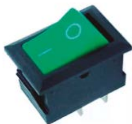
RAC4084 Chave Gangorra KCD11-101 3A 250V Verde Mini c/ Marcação
